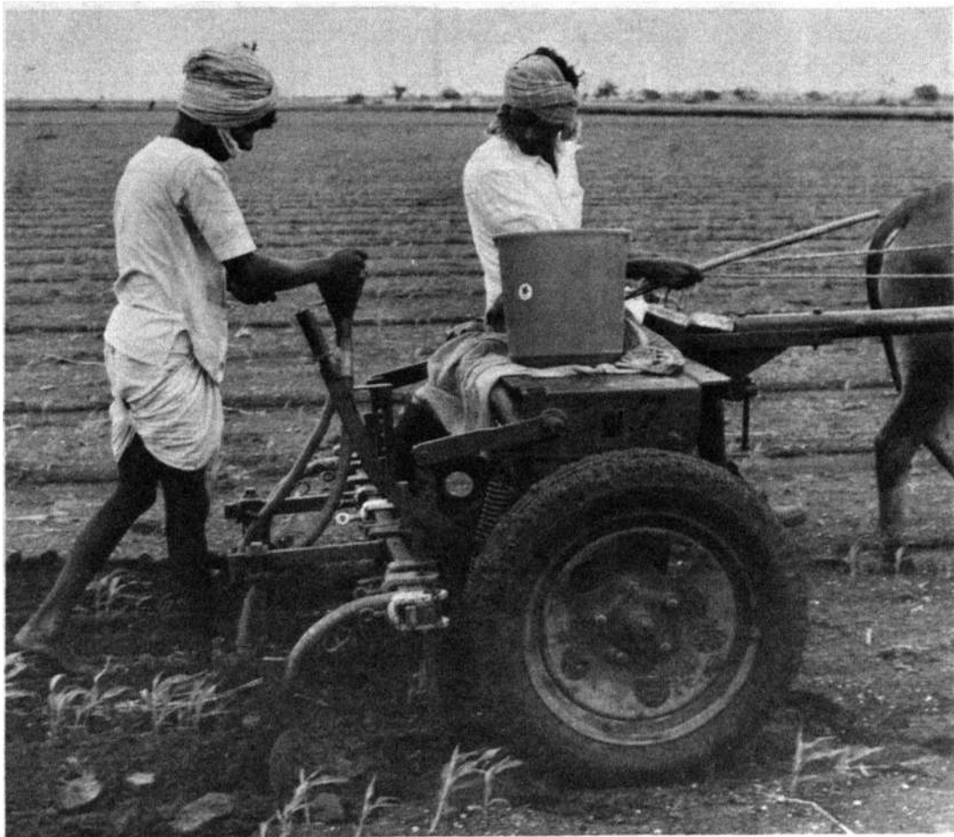
Ce Tropiculteur utilise en Inde est équipé d'un dispositif d'épandage d'engrais en surface, peu coûteux, à alimentation manuelle.
