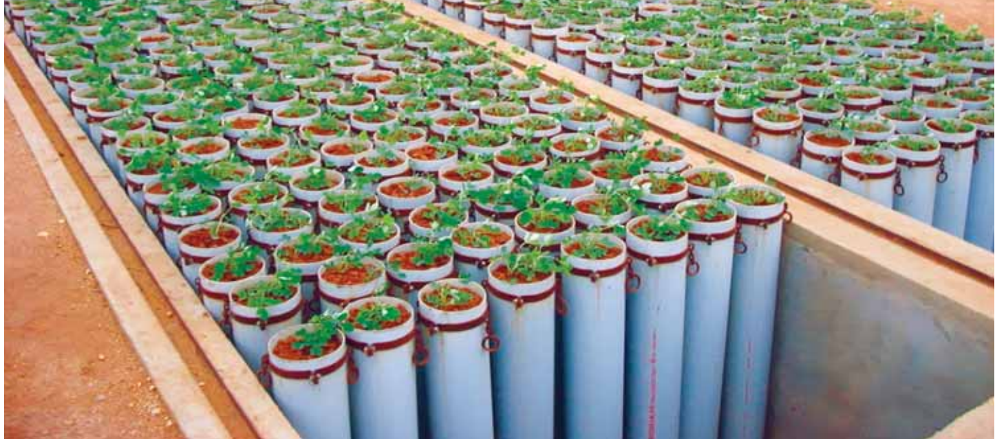
L'installation lysimétrique à grande-échelle vu ici avec des plants d'arachide semés dans des cylindres.
