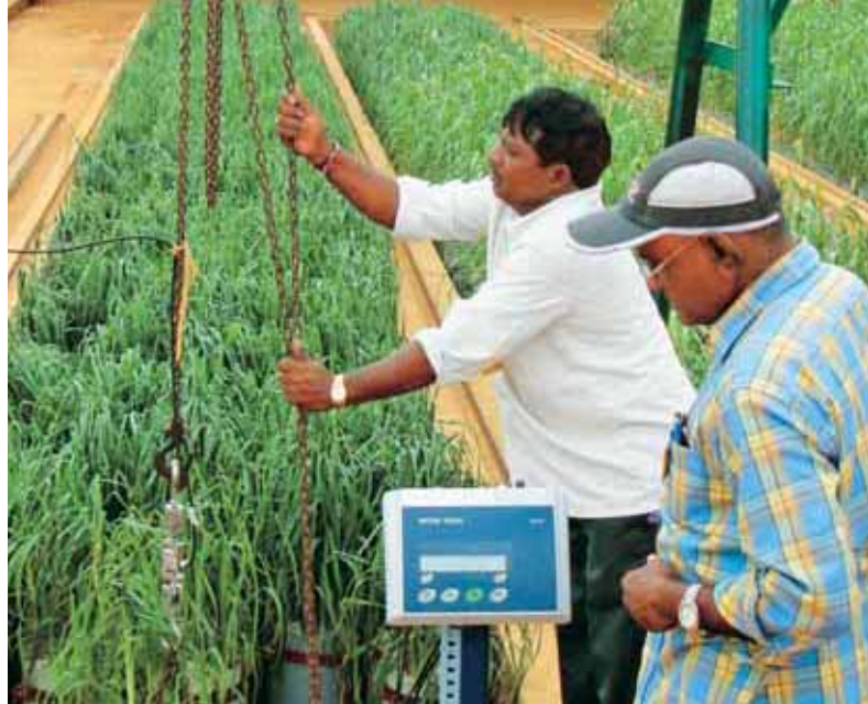
Pesage des cylindres PVC pour évaluer l'eau utilisée par la plante pour la transpiration.
