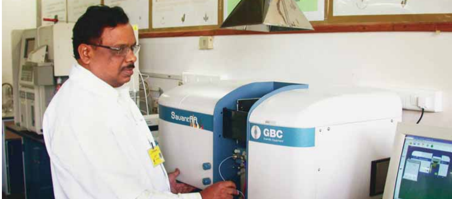
Estimation des macros et des micros éléments nutritifs à l'aide d'un Spectrophotomètre Absorption Atomique.
